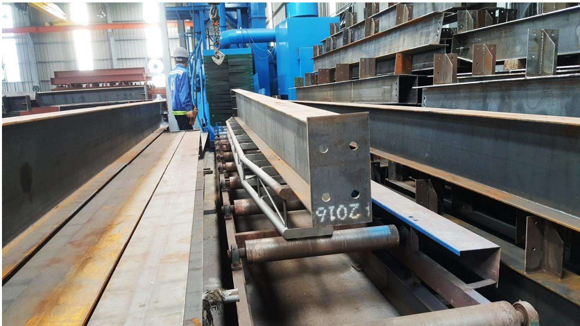
Làm sạch cấu kiện bằng hệ thống Phun bi
